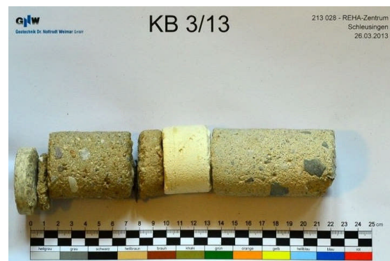
Bohrkern mit Dämmmaterial aus Vermiculith
