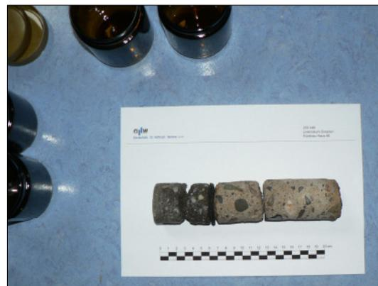
Bohrkerne aus Fußboden mit PAK-haltiger Sperrschicht
