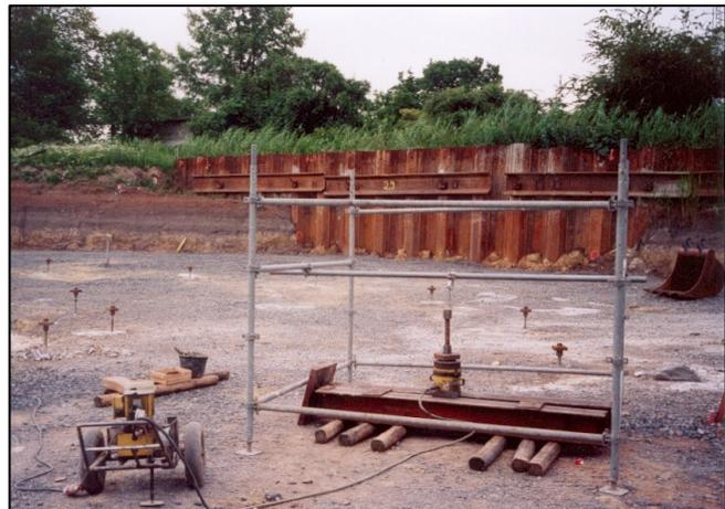
Zugversuch an GEWI-Pfahl (Auftriebssicherung) im RÜB
