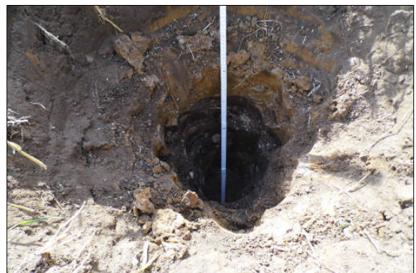
Sondierung im Bereich der Altlastenverdachtsfläche
